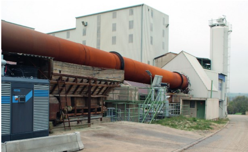
Bild 12 Drehrohrofen mit ORC-Anlage
