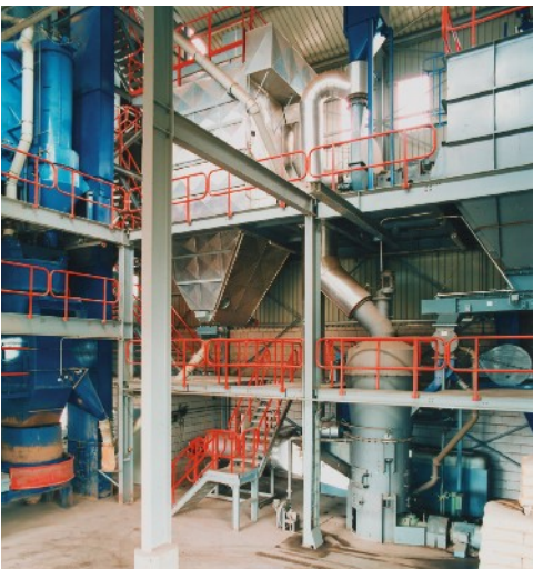
Bild 4 Mahltrocknungs-Misch- und Granulieranlage
