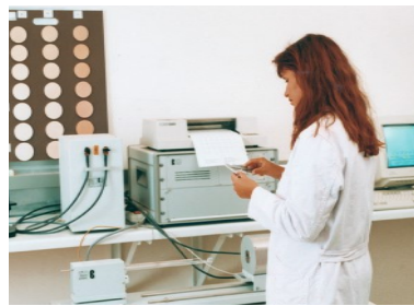
Bild 10 Einblick im Labor: Dilatometermessung (l.) und RFA-Analyse (r.)
