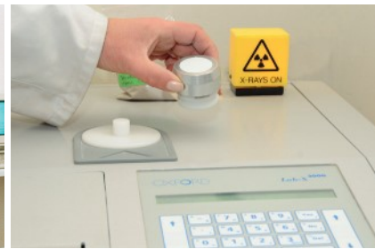
Bild 10 Einblick im Labor: Dilatometermessung (l.) und RFA-Analyse (r.)
