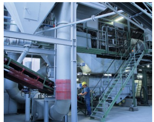
Bild 15 Schamottekühlsystem mit Wärmerückgewinnung am Drehrohrofen II
