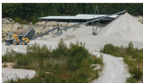
Bild 11 Pegmatitgrube Thansüß (v. l. n. r.): Gewinnung, Siebanlage und Verladung
